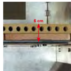
Volano Termico Doppia piastra + refrattario. Thermal Flywheel Double plate + refractory.
